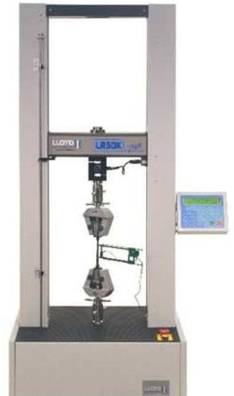
$\Rightarrow$  La **contrainte**  $\sigma$  est le rapport de la force exercée  $F$  par la surface  $S_0$  sur laquelle elle s'applique :  $\sigma = \frac{F}{S_0}$
